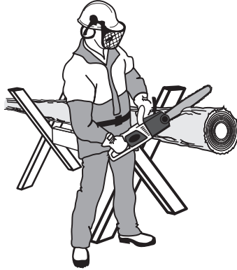
Рисунок 12. Схема розпилювання колоди із використанням козел.
