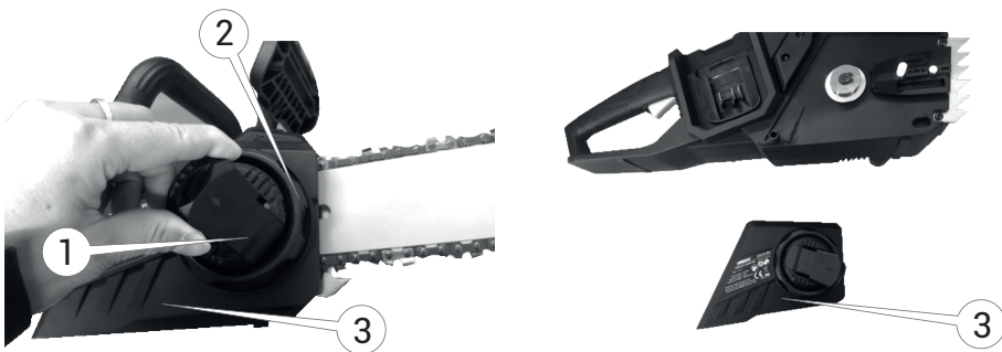
Рисунок 3. Схема зняття кришки кріплення «шини».
