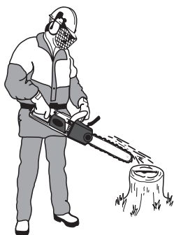
Рисунок. 9. Перевірка працездатності системи змащення напрямної та ланцюга
