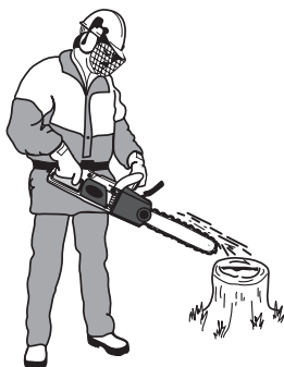
Рисунок. 7. Перевірка працездатності системи змащення напрямної та ланцюга
