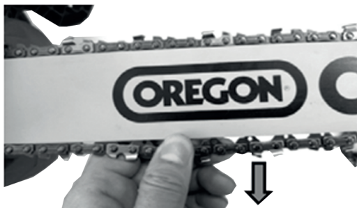
Рис. 7. Схема перевірки натяжіння ланцюга.
