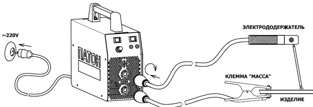
Рис.2. Схема подключения аппарата для сварки штучными электродами
