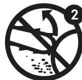
Рис.3: 1,2 Забороняється працювати кінцем шини!
