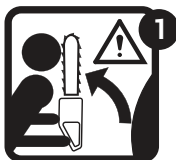
Рис.3: 1,2 Забороняється працювати кінцем шини!
