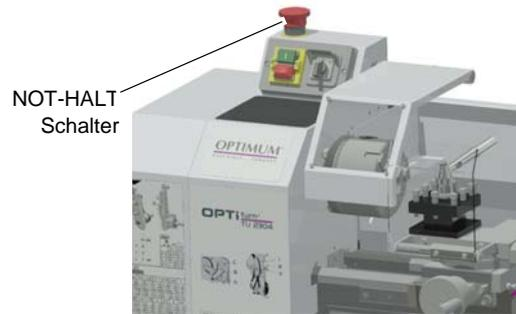
Abb. 1-2: Not-Halt Pilzkopfschalter
