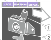
Рисунок 8. Регулювання подачі палива
