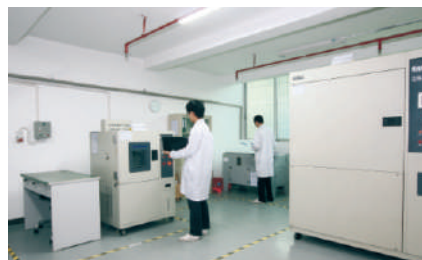
Лаборатория для проведения испытаний на термические удары
